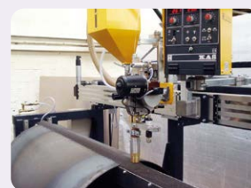
KA 2-UP zum Längsnahtschweißen mit Badsicherung
